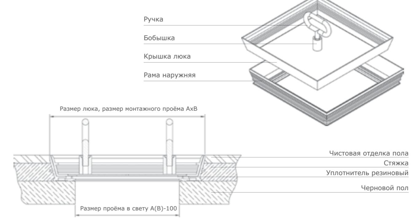
ЗАПОЛНЕНИЕ КРЫШКИ ЛЮКА РАЗМЕРАМИ БОЛЕЕ 600Х600 ММ
