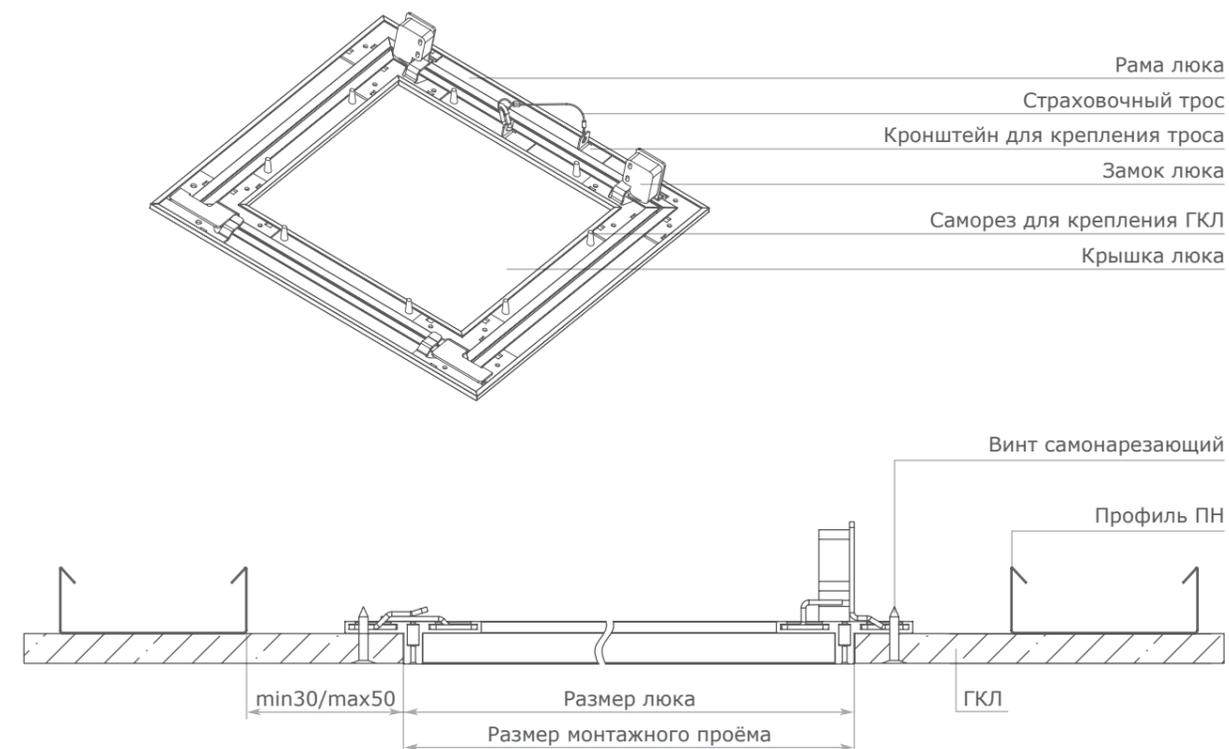
Установить люк можно быстро и просто – специальных навыков для этого не требуется. При использовании ревизионных люков в зданиях и помещениях с влажными и мокрыми средами, лицевую поверхность следует защищать нанесением водостойкой грунтовки, шпатлёвки, краски. В таких помещениях следует также предусмотреть вытяжную вентиляцию, обеспечивающую воздухообмен, соответствующий требованиям действующих строительных норм на отопление, вентиляцию и кондиционирование.
