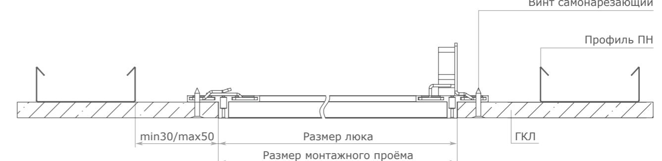
Установить люк можно быстро и просто – специальных навыков для этого не требуется. При использовании ревизионных люков в зданиях и помещениях с влажными и мокрыми средами, лицевую поверхность следует защищать нанесением водостойкой грунтовки, шпатлёвки, краски. В таких помещениях следует также предусмотреть вытяжную вентиляцию, обеспечивающую воздухообмен, соответствующий требованиям действующих строительных норм на отопление, вентиляцию и кондиционирование.
