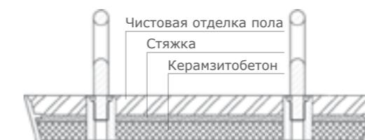
ЗАПОЛНЕНИЕ КРЫШКИ ЛЮКА РАЗМЕРАМИ МЕНЕЕ 600Х600 ММ
