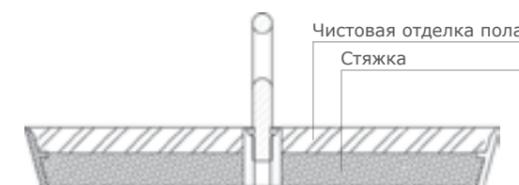
Для предотвращения попадания пыли, влаги и проникновения в помещение и в пространство под полом запахов, крышка люка снабжена резиновым уплотнителем, обеспечивающим плотное прилегание крышки люка к раме. Монтаж люка быстр, прост и не требует специальных навыков.
